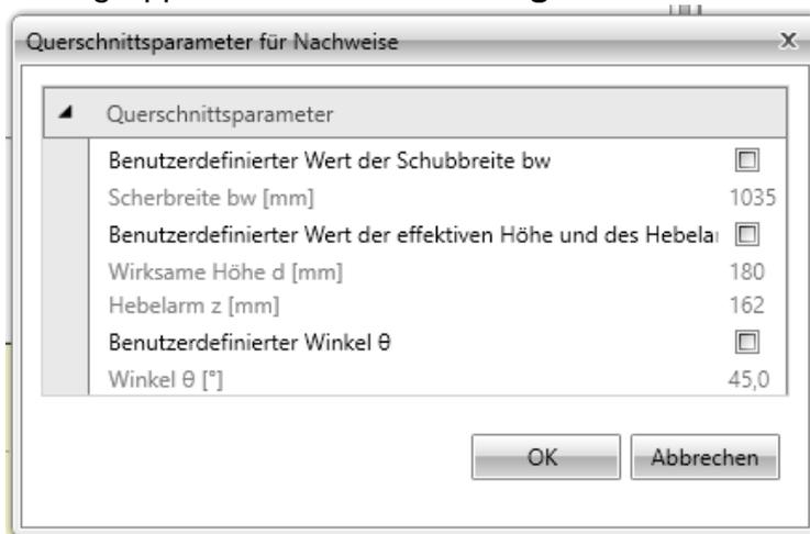
Im Dialog werden berechnete Werte der wirksamen Querschnittsabmessungen und überschreibbare Werte des Schernachweises aus den Norm- und Berechnungseinstellungen angezeigt. Um die Eingabe benutzerdefinierter Werte zu ermöglichen, aktivieren Sie das Kontrollkästchen in der ersten Spalte.
