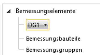
Für den Nachweis der Struktur müssen die Bemessungsbauteile definiert werden. Bemessungsbauteile, die ähnlich nachgewiesen werden sollen, sollten einer Bemessungsgruppe zugewiesen werden.
