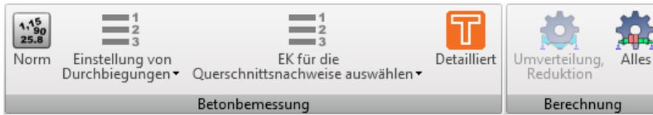
Zum Ausführen des Betonnachweises im Modul IDEA RCS klicken Sie **Detailliert** in der Untergruppe **Betonbemessung**.
