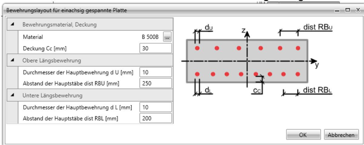
Im Dialog werden der Abstand zwischen Stäben, die Stabnummern, die Stabdurchmesser, die Stabmaterialien und die Betondeckungen definiert.
