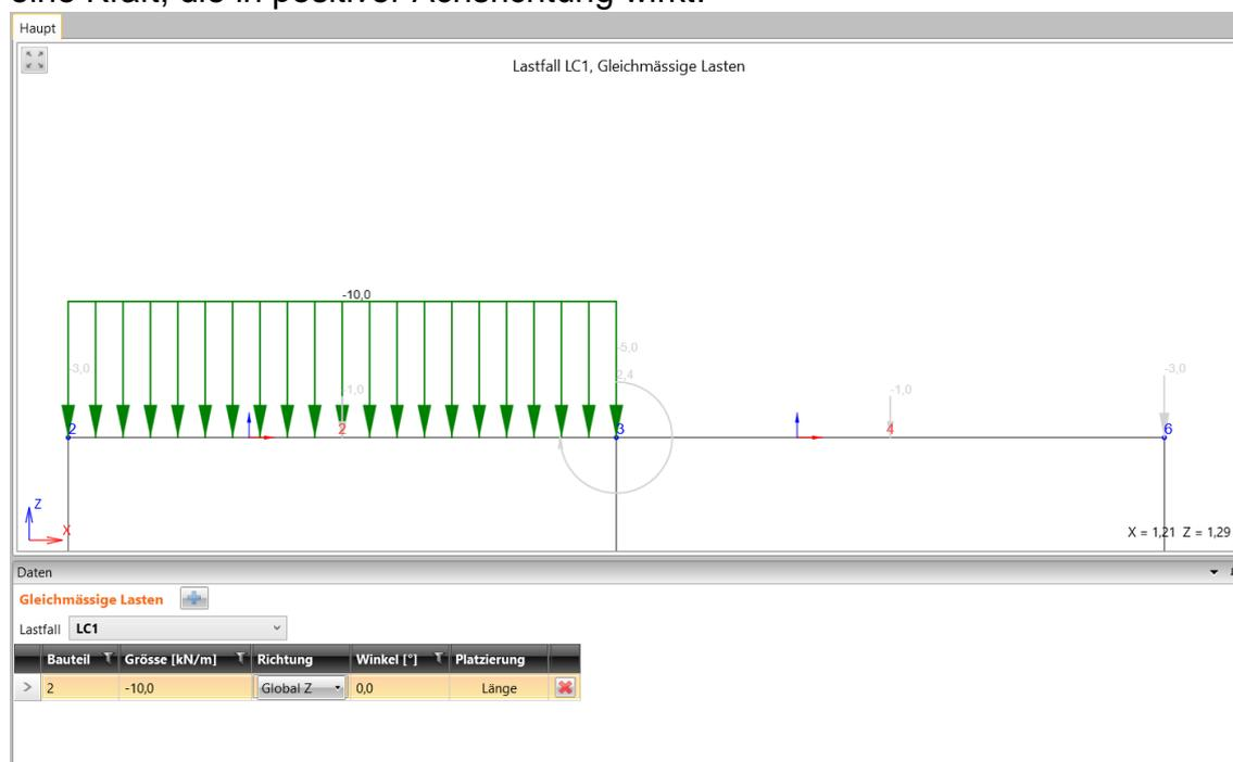
Der entsprechende Lastfall kann über die Liste **Lastfall** eingestellt werden. In diesem Lastfall bereits definierte gleichmäßige Lasten werden in der Tabelle angezeigt.
