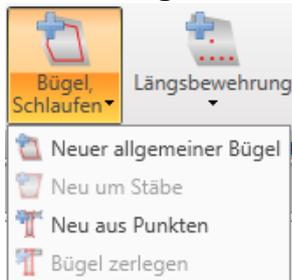
Einstellungsmöglichkeiten des Drop Down-Buttons **Bügel, Schlaufen** in der Untergruppe **Bewehrung**:
