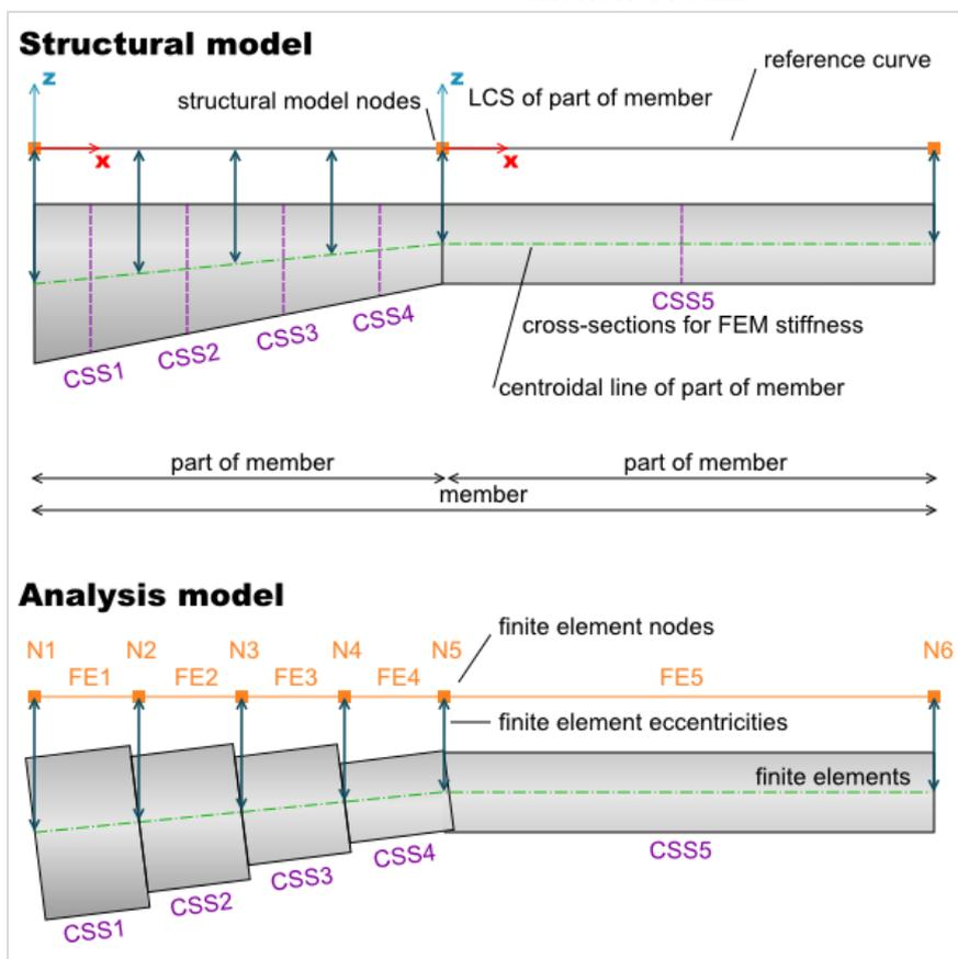
Übertragen des Strukturmodells in das Analysemodell (Finite Elemente für die Analyse)
