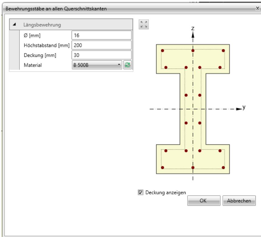
An jeder Querschnittskante wird eine Bewehrungslage erzeugt. Die Ermittlung der Stabanzahl an der Kante erfolgt automatisch, unter Berücksichtigung des angegebenen maximalen Stababstands und des Stabdurchmessers.
