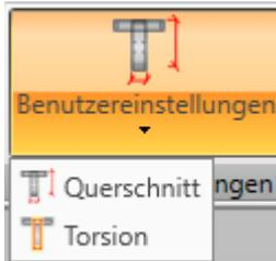
Bearbeiten von Parametern zur Schub- und Torsionsberechnung des bewehrten Querschnitts in der Untergruppe **Benutzereinstellungen**:
