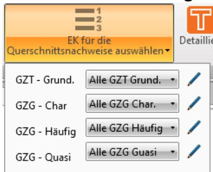
Vor dem Durchführen von Abschnittsnachweisen müssen die Ergebnisklassen des aktuellen Bemessungsbauteils ausgewählt werden.
