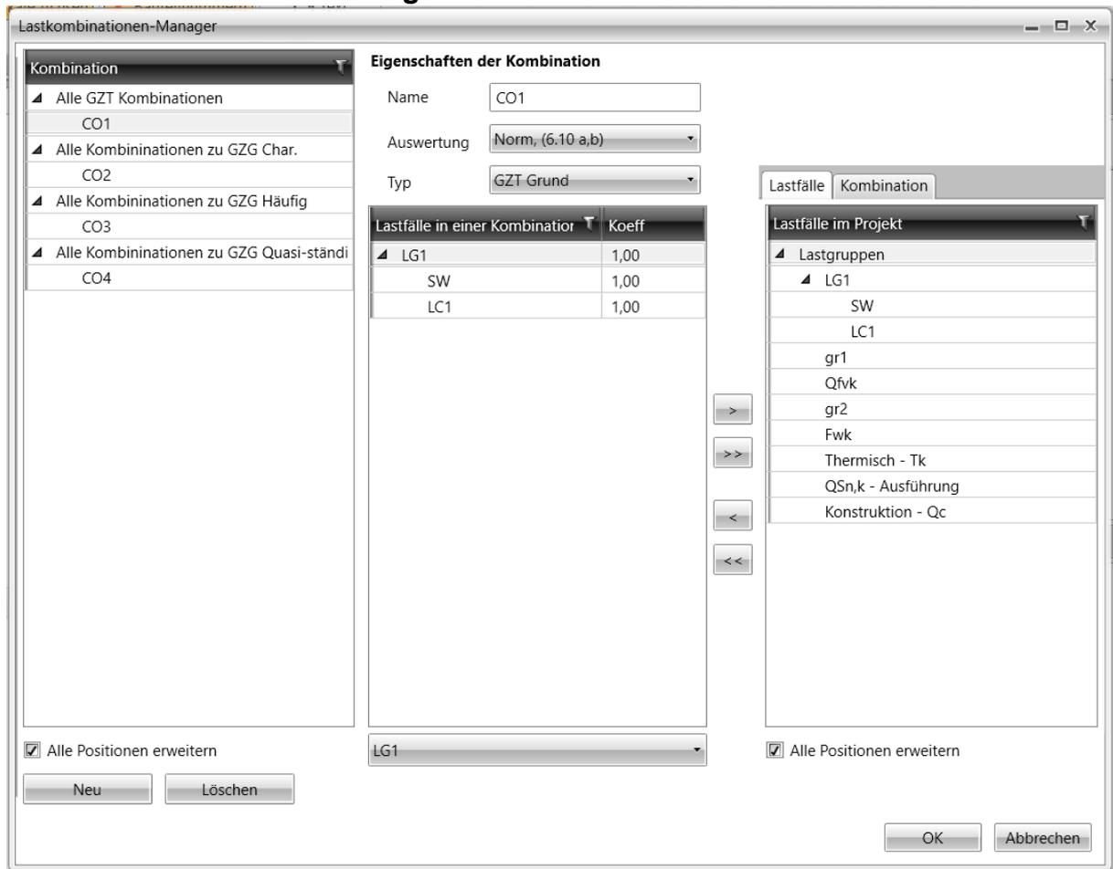
Lastfallkombinationen sind wichtig zur Bestimmung der Extremwerte von Lasten. Es ist möglich, verschiedene Typen von Kombinationen einzugeben, die für verschiedene Bemessungen und Nachweise verwendet werden:
