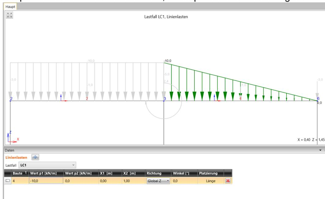
Der entsprechende Lastfall kann über die Liste **Lastfall** eingestellt werden. In diesem Lastfall bereits definierte Linienlasten werden in der Tabelle angezeigt.
