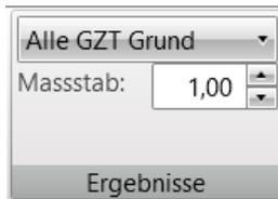
Für die aktuelle Ergebnisklasse, den aktuellen Lastfall oder die aktuelle Kombination (auswählbar in der Liste der Untergruppe **Ergebnisse**) werden die Lagerreaktionen, Verformungen und die Schnittgrößen ausgewertet.
