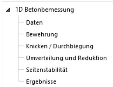
Die Befehle in der Untergruppe **1D Betonbemessung** dienen zur Definition von Bewehrungszonen, zur Zuordnung von Bewehrung zu Zonen, zur Definition von Auflagern zur Durchbiegungsberechnen, zur Definition von Randbedingungen für die Berechnung der Umverteilung und Reduktion und zur Ergebnisauswertung der Abschnittsnachweise und der Durchbiegungsberechnung.
