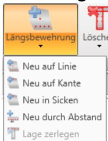
Der Dropdown Button **Längsbewehrung** in der Untergruppe **Bewehrung** beinhaltet Befehle für Operationen mit Längsbewehrung:
