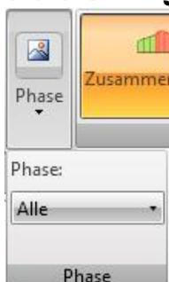
Für abgestufte Bauteile kann die aktuelle Phase aus der Liste **Phase** ausgewählt werden. Die Ergebnisse werden für diese Phase angezeigt.
