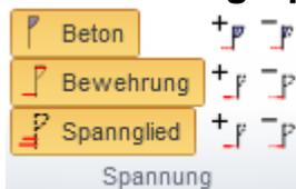
Anzeige der Spannungsverläufe. Für Spannglieder nur bei abgestuften Abschnitten verfügbar:
