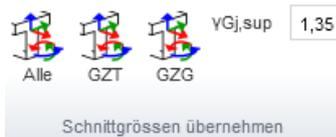
Komponenten von ständigen Lasteinwirkungen für entsprechende Kombinationen können aus den Einwirkungsphasen übernommen werden. Beim Übernehmen einer Lasteinwirkung aus den Einwirkungsphasen wird die Summe aller charakteristischen Lasten aus allen Phasen aus dem gleichen oder geringen Alter als dem der aktuellen Lastextreme.
