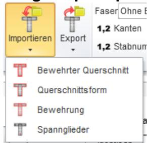
Einstellungsmöglichkeiten des Drop Down-Buttons **Importieren** zum Importieren von bewehrten Querschnitten (Geometrie, Bewehrung) aus einer Textdatei (Format \*.NAV) – Siehe **16 Format von Textdateien für den Import und Export**.
