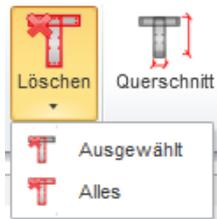
Einstellungsmöglichkeiten des Drop Down-Buttons **Löschen** in der Untergruppe **Bewehrung** zum Löschen von Bewehrung aus dem Querschnitt:
