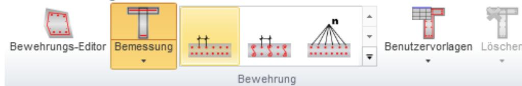
Zum Definieren von Bewehrung an bestimmten Flächen auf einachsig gespannten Platten stehen Basisvorlagen zur Verfügung, auswählbar in der Untergruppe **Bewehrung**:
