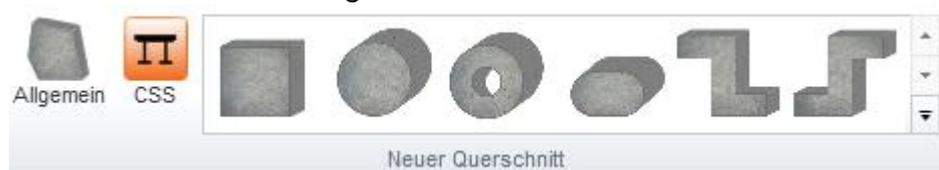
Für Abschnitte mit Phasen verfügbare Querschnitte (Lizenz für zeitabhängige Analyse erforderlich):
