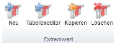
Zum Hinzufügen, Kopieren oder Entfernen von Extremlasten klicken Sie **Extremwert**.
