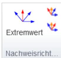
Klicken Sie auf die Buttons in der Untergruppe **Nachweisrichtungen**, um zwischen den Richtungen zu wechseln. Anschließend werden die Ergebnisse für die vorherige/nächste Nachweisrichtung angezeigt.
