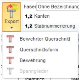
Einstellungsmöglichkeiten des Drop Down-Buttons **Export** zum Exportieren von bewehrten Querschnitten (Geometrie, Bewehrung) aus einer Textdatei (Format \*.NAV):
