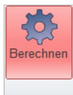
Zur Neuberechnung von Schnittgrößen in einer übergeordneten Anwendung, klicken Sie auf den Button **Berechnen**. Der Hintergrund des Buttons wird rot hinterlegt, wenn eine Neuberechnung erforderlich ist - beispielsweise nach Änderungen der Spanngliedgeometrie.
