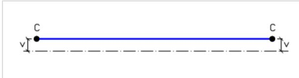
Dieses Segment besteht nur aus einem geometrischen Element - einer geraden Linie. Es kann nicht mit einem anderen Segment verbunden werden und kann nur als eigenständiges Segment verwendet werden. Die Form wird mit zwei C-Punkten definiert. Der Punkt C befindet sich immer am Anfang oder am Ende des Segments und seine Position wird durch den Abstand  $v$  von der Bezugskurve des Bauteils in der XY- oder der XZ-Ebene definiert.
