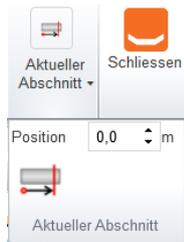
Verwenden Sie die Untergruppe **Aktueller Abschnitt** zum Einstellen der Position des Abschnitts auf dem Bemessungsbauteils, für den Informationen zum Querschnitt im Informationsfenster angezeigt werden sollen. Der Wert der Position kann unter
