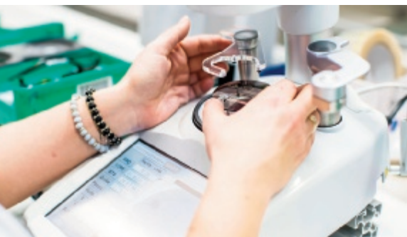
Hier wird eine Linse vermessen, um den optischen Mittelpunkt zu bestimmen. Von diesem Punkt aus erfolgt das Maßnehmen fürs Einschleifen in den Rahmen
